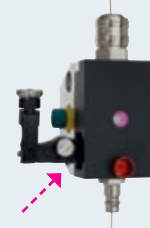
Шаг 5: Зафиксировать шатун с крышкой корпуса
